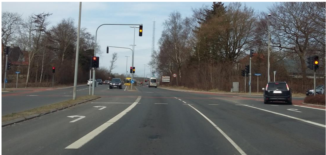
Figur 2: Bundet venstresving uden delehelle i et 4-benet kryds.
